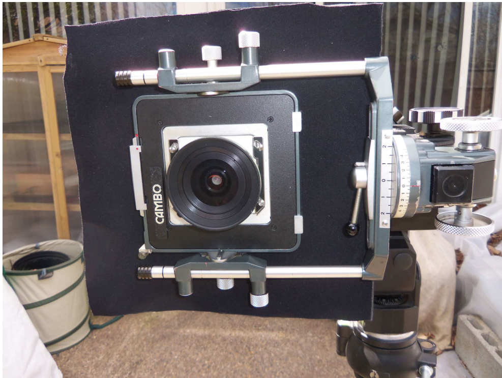
FIGURE 4 – Le soufflet presque complètement comprimé, avec le 35 mm focalisé à l'infini
