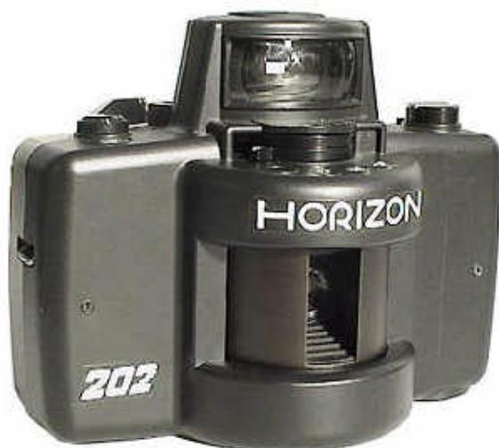
Panoramique mécanique utilisant un objectif à prise de vue circulaire. Au déclenchement, l'objectif tourne doucement sur un angle de 120°, donnant des photographies de haute résolution et naturelles. Cette technologie existe depuis 1843 (le premier appareil panoramique fut autrichien, comme les Lomo !). L'ouverture et l'obturation sont manuels, permettant d'exposer suivant ses besoins et son goût.
