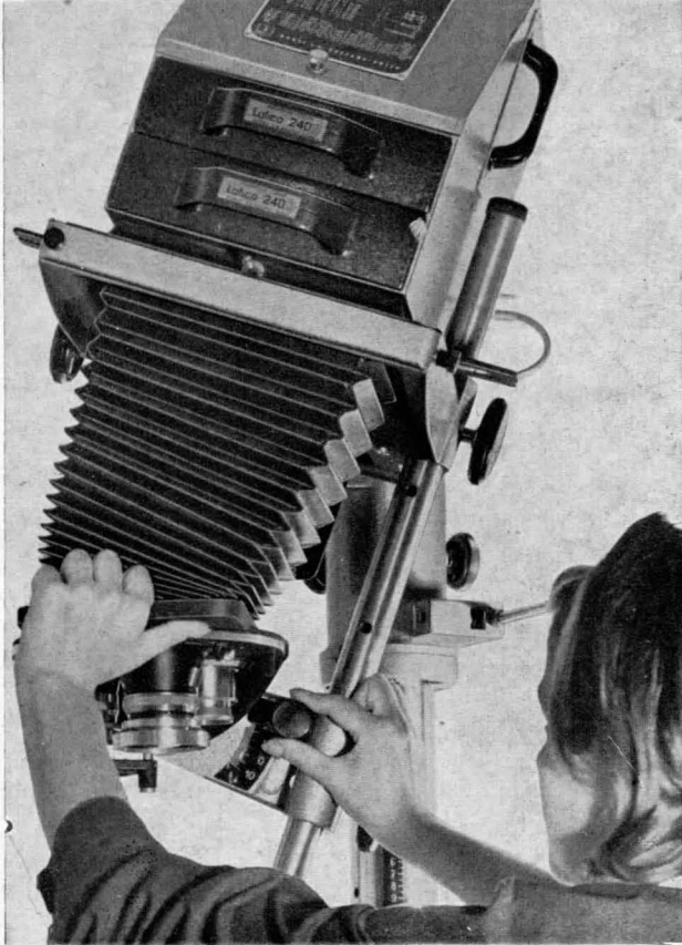
Fig. 5 c. Inclinaison du porte-objectif. Le réglage latéral de l'objectif se fait par inclinaison de la tourelle vers la droite.
