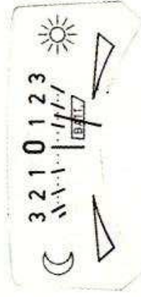
Contrôle de la pile
