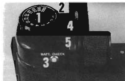
1. Barillet des vitesses. — 2. Encoche de couplage au prisme/posemètre TTL. — 3. Poussoir du test de pile. — 4. Diode rouge du test de pile, faisant également office de repère pour la sélection des vitesses. — 5. Numéro de série.
