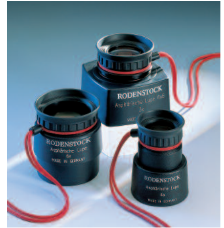
Die 3fach-Lupe (oben) zeigt ein großes Bildfeld von 6x6 cm, die 4fach-Lupe (rechts) das volle Kleinbildformat oder einen 41 mm großen Kreis, die 6fach-Lupe (links) deutlich mehr als Kleinbild oder einen 57 mm großen Kreis.
