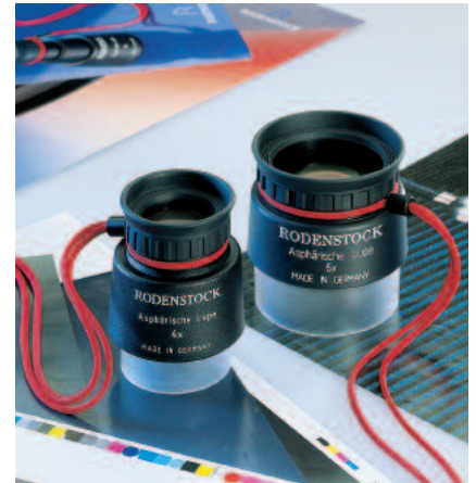
Zur Betrachtung mit Auflicht wird bei der 4fach-Lupe (links) der Schiebetubus nach oben verschoben, bei der 6fach-Lupe (rechts) und der 3fach-Lupe der Umstecktubus mit dem transparenten Teil nach unten umgesteckt.
