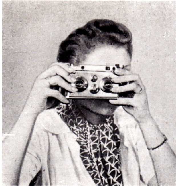
Mauvaise Position Doigts sur la plaque porte objectif.
