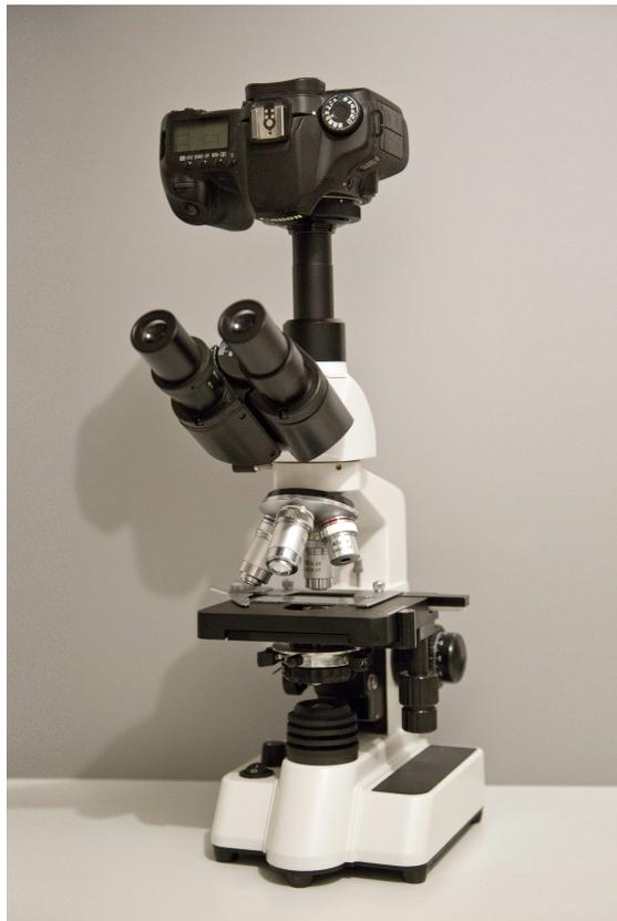
FIGURE 6 – Le microscope à sortie trinoculaire utilisé pour voir le grain des films
