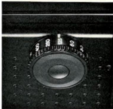
Sélectionner une vitesse d'obturation. En tournant le barillet, placer la vitesse choisie en face de l'index. La vitesse doit toujours être positionnée sur un cran et ne jamais rester entre les deux.
