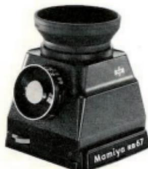
Ce viseur loupe comporte un dispositif de mesure spot par une cellule CDS TTL. Du fait de la mesure de lumière à travers l'objectif, il est possible d'obtenir facilement une mesure exacte quel que soit le tirage ou malgré l'utilisation de bagues macro ou de filtres.
