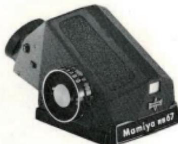
Un système de cellule CDS est incorporé dans un viseur à hauteur d'oeil du type prismatique. La cellule mesure la lumière sur la totalité de l'image avec néanmoins une prédominance sur la partie centrale.
