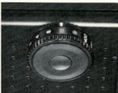
Lorsque le barillet des vitesses est placé sur B, l'obturateur reste ouvert aussi longtemps que l'on appuie sur le déclencheur. Grâce à la commande électronique, il se ferme automatiquement après une minute de manière à sauvegarder la pile. Sur position (B), une alarme sonore retentit environ 50 secondes, après le déclenchement.
