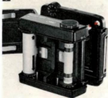
6. Remettre le porte-film dans la cassette extérieure en s'assurant que le dispositif de couplage d'avance du film se place correctement dans l'ouverture de la cassette.
