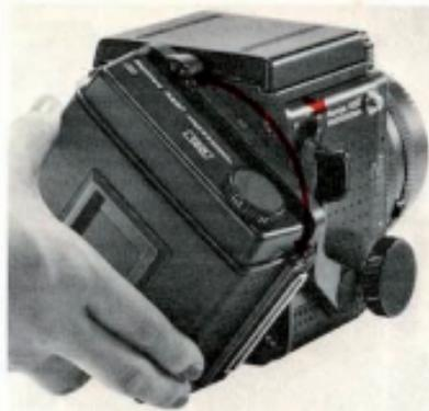
Pour modifier la position du dos, il faut placer le levier R.M. sur "R". Pour passer du cadrage horizontal au cadrage vertical, tournez le dos dans le sens des aiguilles d'une montre jusqu'à ce qu'il bute. Tourner en sens inverse pour revenir au cadrage horizontal.
