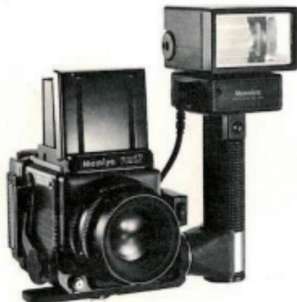
C'est un flash très polyvalent de 36 de nombre guide (ASA/ISO 100 en mètres). Il est automatique et offre le choix entre 3 diaphragmes en mode automatique. La tête du flash est orientable pour permettre l'éclairage indirect. Il peut tourner de 90° vers le haut, 180° à gauche et 150° à droite.
