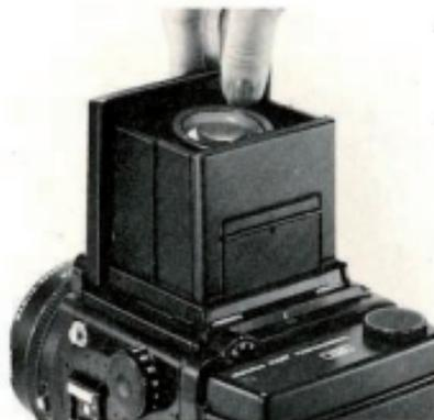
Abaisser la loupe en appuyant sur sa partie inférieure jusqu'à ce qu'elle se verrouille en place.
