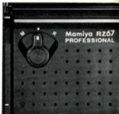
Avant d'essayer d'avancer le film jusqu'à la première vue, vérifier que le levier RM est sur sa position normale (centre). S'il se trouve sur "M" (surimpression) le film n'avancera pas en appuyant sur le levier d'armement.
