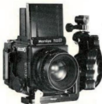
La poignée orientable se compose d'une barrette et d'une poignée qui peut être orientée et verrouillée par crantage tous les 20°. Le déclencheur est sur la gâchette de la poignée qui est couplée au déclencheur de l'appareil. La poignée a une rotation libre de la griffe porte-accessoires et possède un blocage du déclencheur.
