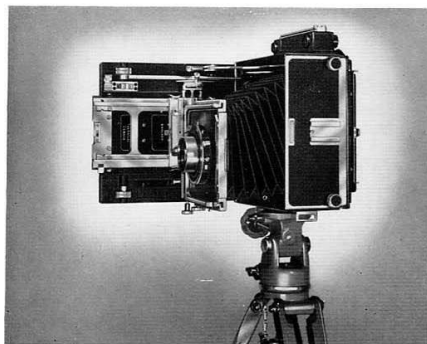
L'appareil utilisé avec décentrement vers le bas d'un point de vue plus élevé donne la troisième dimension de l'objet
