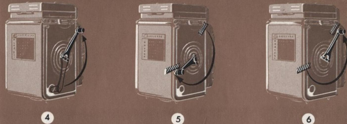
Ecarter la manivelle ④; la faire tourner d'un mouvement continu jusqu'à l'arrêt ⑤, puis revenir en arrière jusqu'à un nouvel arrêt ⑥!
