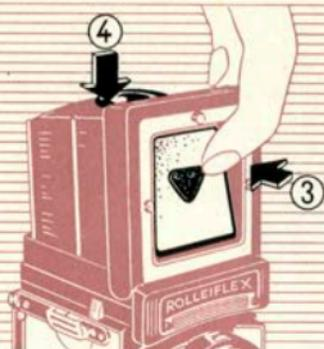
**Mise au point:** Tourner la molette et contrôler en même temps la netteté sur le dépoli. S'il y a lieu, se servir de la loupe, la tenant contre l'œil. Les distances gravées sur la molette servent uniquement pour la détermination de la profondeur de champ (➤ page 19).
