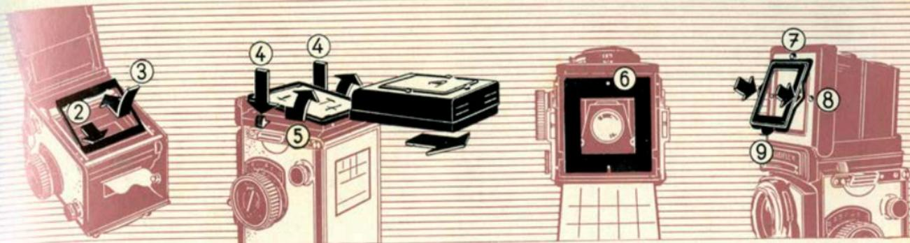
**Mettre en place le cache de film:** Introduire le cache par le bord à ressort – d'abord en bas (2) et ensuite en haut derrière le cadre de film (3). – Enlèvement: pousser le cache vers le bas et le retirer.
