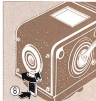
**Ouverture de l'appareil:** Pousser latéralement le verrou de sûreté (sur la base de l'appareil) ①, déverrouiller le dos ② et l'ouvrir.
