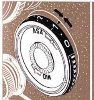
Dans des cas exceptionnels (vues flash, coefficients de filtre élevés, au-dessus de -3), la correction de la lumination pour le coefficient de filtre consiste à retrancher 3° DIN par unité de coefficient de filtre (par exemple: filtre gris -4; régler le posemètre sur une rapidité  $4 \times 3 = 12^\circ$  DIN inférieure à la rapidité du film employé).
