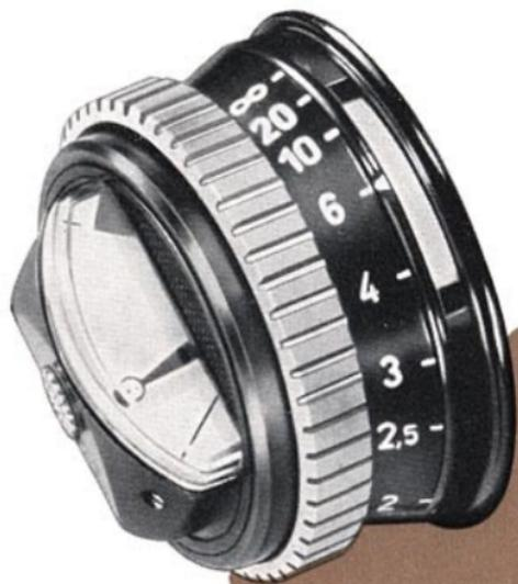
Une image de visée nette assure un réglage correct de l'appareil sur la distance du sujet principal. Cependant, dans un certain espace en avant et en arrière du sujet visé (et réglé), il y a toujours une netteté suffisante de l'image. Cette zone de « profondeur de champ » est indiquée par une bande blanche près de la molette de mise au point: la longueur de la bande indique sur l'échelle des distances l'espace de netteté embrassé.
